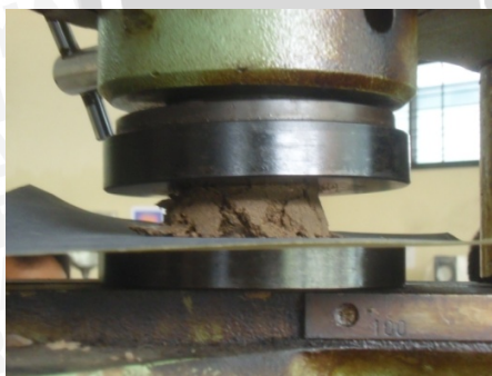
Foto Hasil Pengujian Kekuatan Tekan
