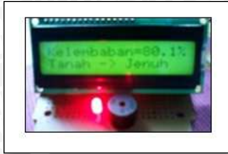
Gambar 5.14 Hasil Pengujian Saat Buzzer Aktif
