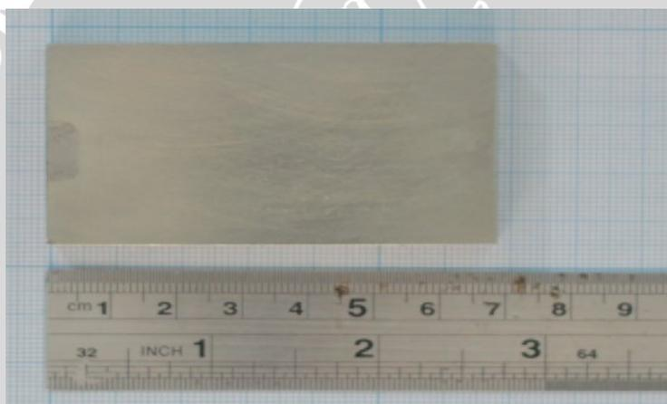
Gambar B. *Pickling* 2,9 A/dm<sup>2</sup> ; 3 menit
