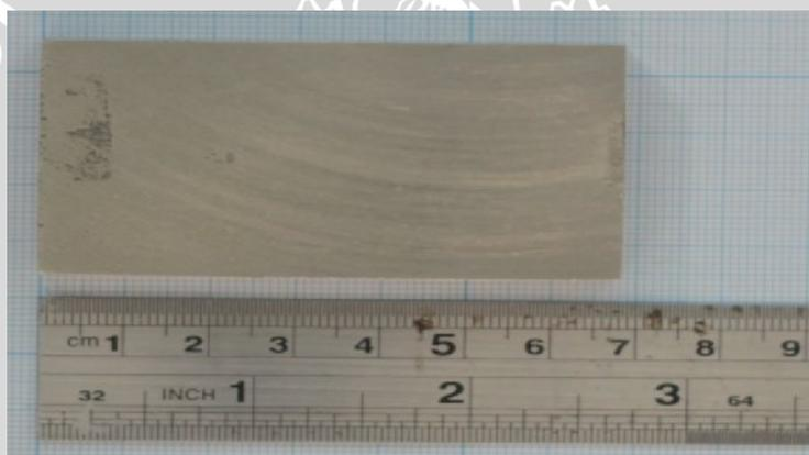
Gambar E. *Pickling* 5,88 A/dm<sup>2</sup> ; 3 menit
