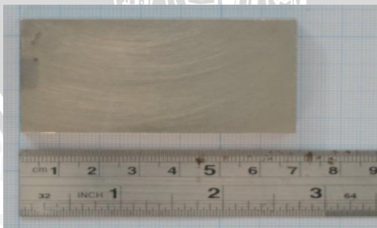
Gambar C. *Pickling* 2,9 A/dm<sup>2</sup> ; 6 menit
