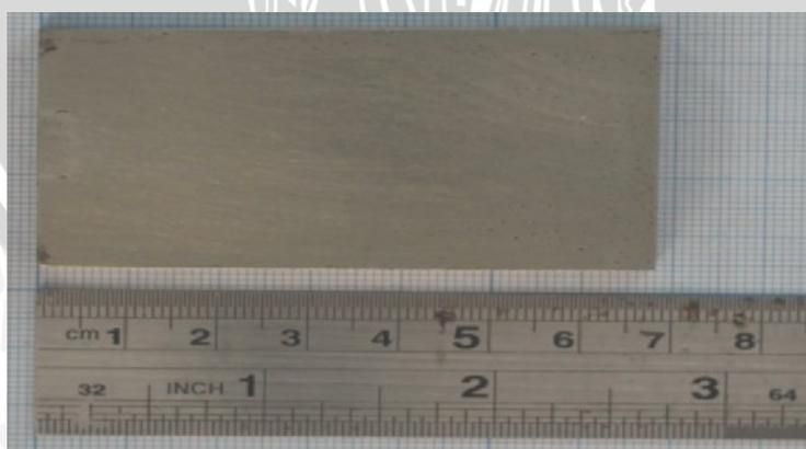
Gambar F. *Pickling* 5,88 A/dm<sup>2</sup> ; 6 menit
