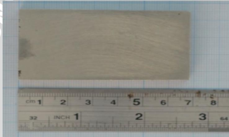
Gambar K. *Pickling* 11,76 A/dm<sup>2</sup> ; 3 menit
