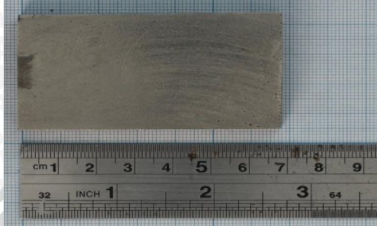
Gambar J. *Pickling* 8,82 A/dm<sup>2</sup> ; 9 menit
