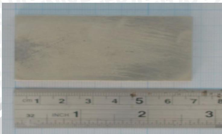
Gambar D. *Pickling* 2,9 A/dm<sup>2</sup> ; 9 menit
