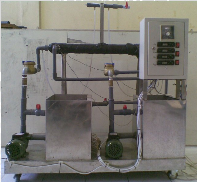
Gambar 5 Instalasi alat penukar kalor
