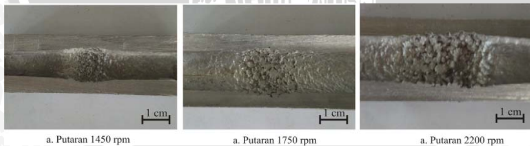
Gambar 4.7 Cacat Pada Permukaan Bagian Dalam Hasil Coran
