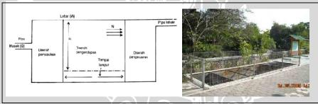
Gambar 4. 76 Skema Instalasi Pengolahan Akhir Limbah Sumber : PDII-LIPI (1991)
