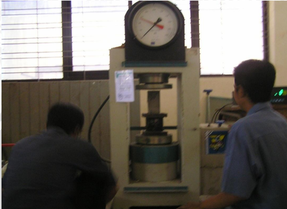
Uji tekan beton silinder
