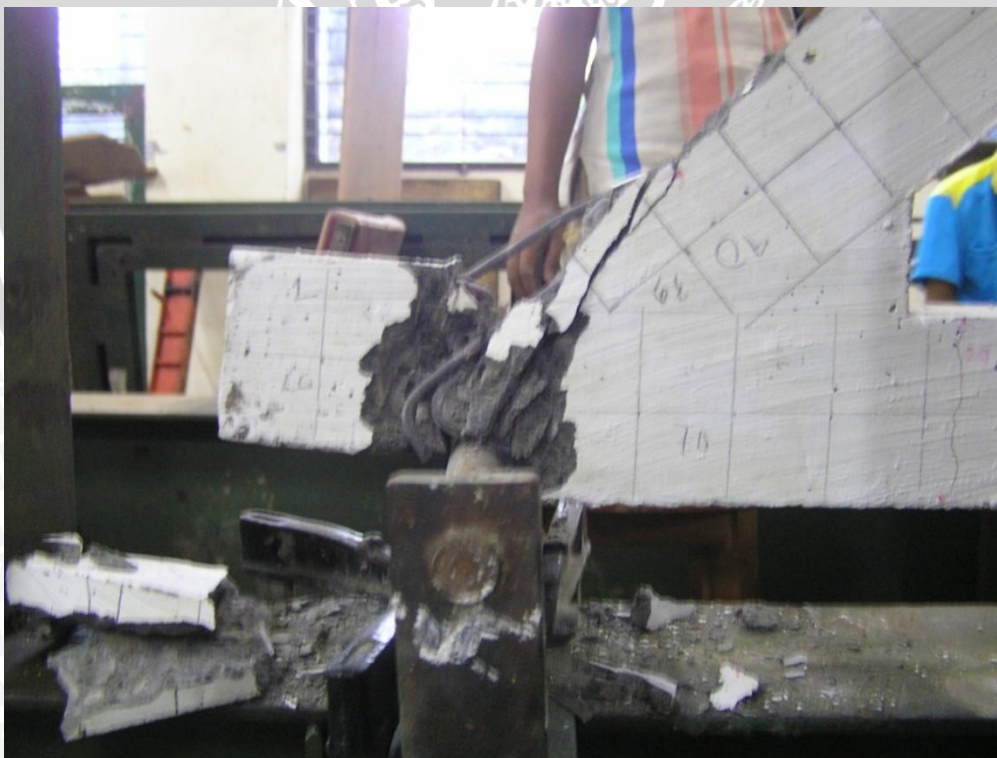
Keruntuhan pada kuda-kuda beton komposit
