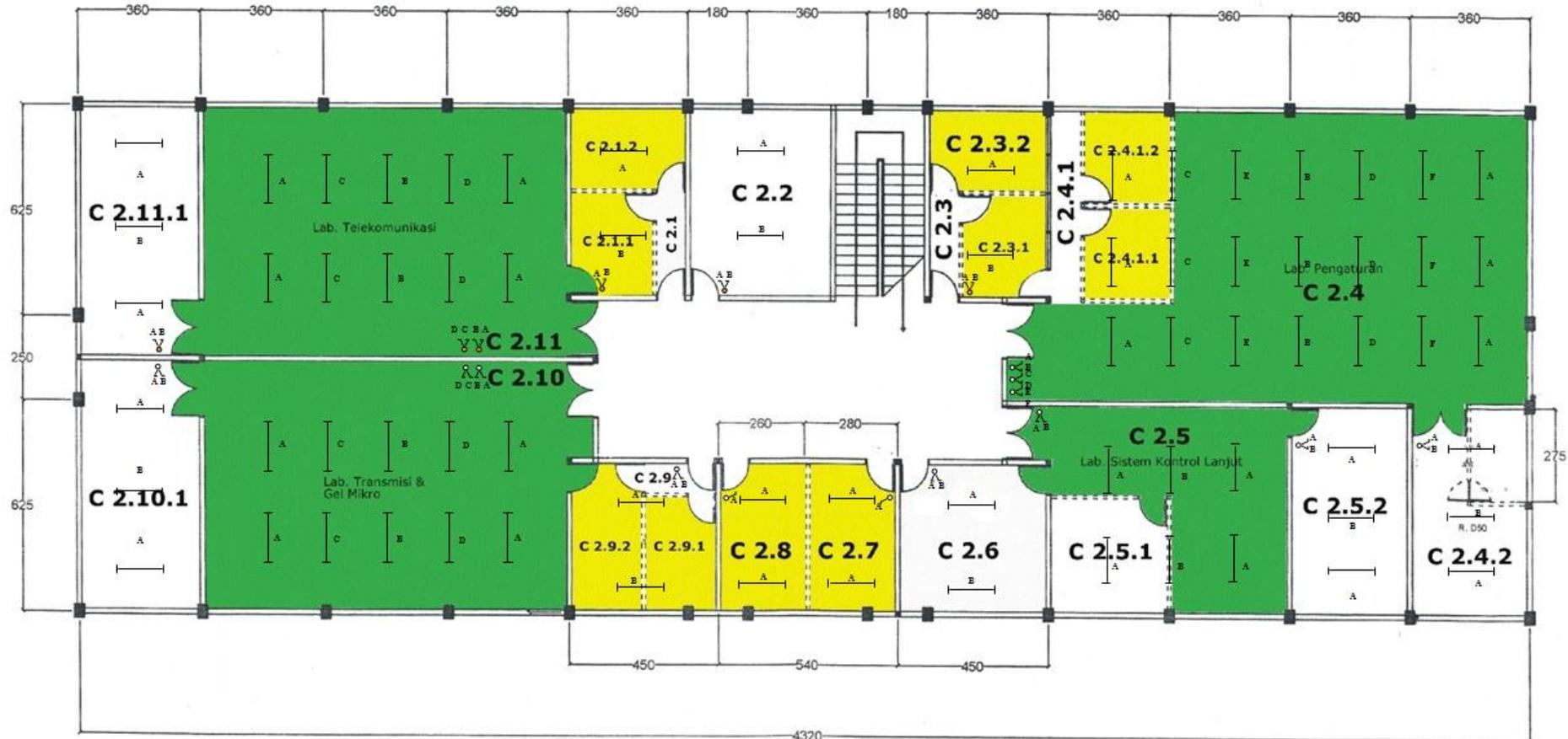
Gambar 4.7 Denah Instalasi Penerangan Lantai 2 Gedung C Jurusan Teknik Elektro Universitas Brawijaya
