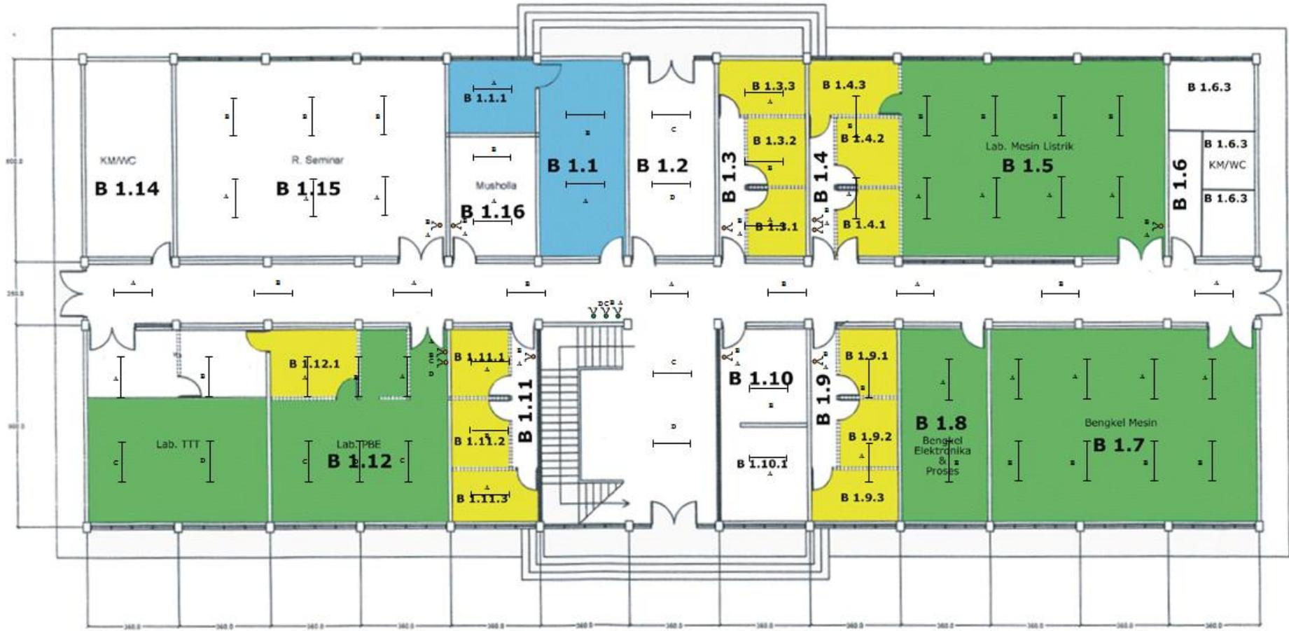
Gambar 4.4 Denah Instalasi Penerangan Lantai 2 Gedung B Jurusan Teknik Elektro Universitas Brawijaya
