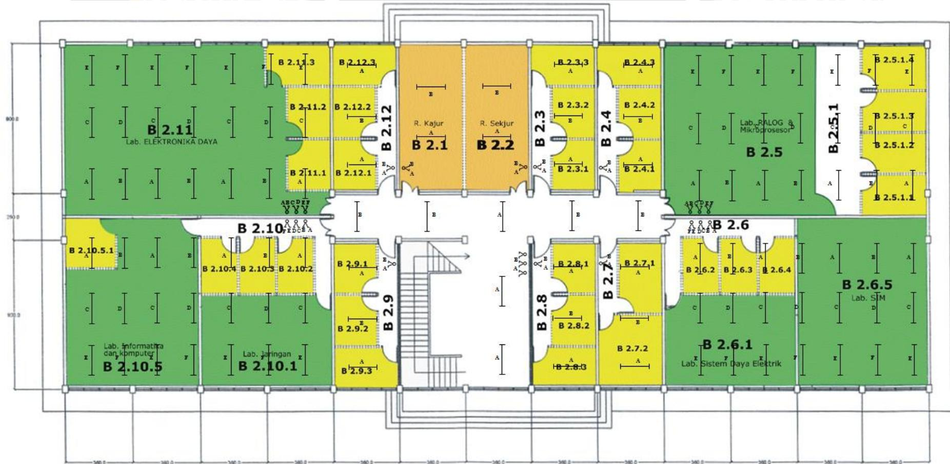
Gambar 4.5 Denah Instalasi Penerangan Lantai 2 Gedung B Jurusan Teknik Elektro Universitas Brawijaya
