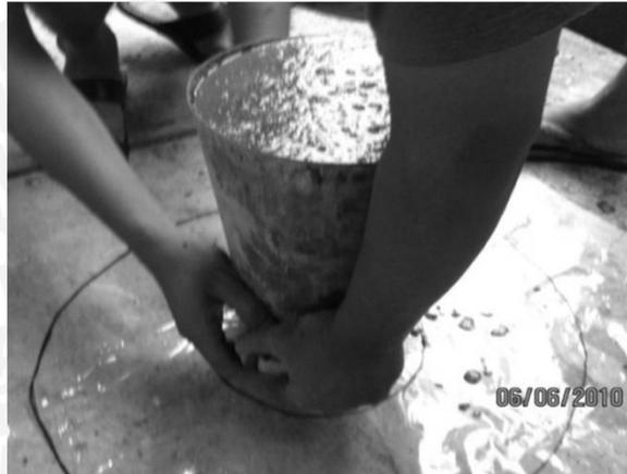
Gambar 4.12 Pengujian *slump flow*
