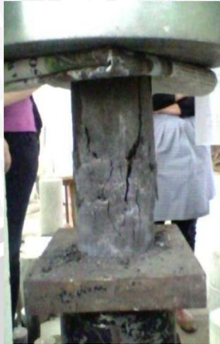
**Gambar 2.8** Model pengujian kuat tekan beton
