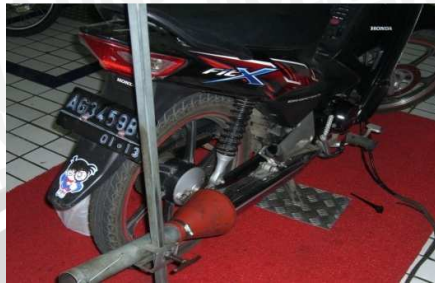
Gambar 3.6 Proses Pengujian Emisi Gas Buang
