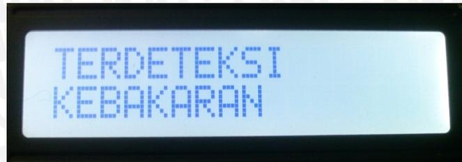
**Gambar 5.63.** Tampilan LCD saat sistem mendeteksi kebakaran
