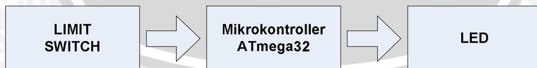
**Gambar 5.1.** Blok diagram pengujian sistem pendeteksi pintu terbuka
