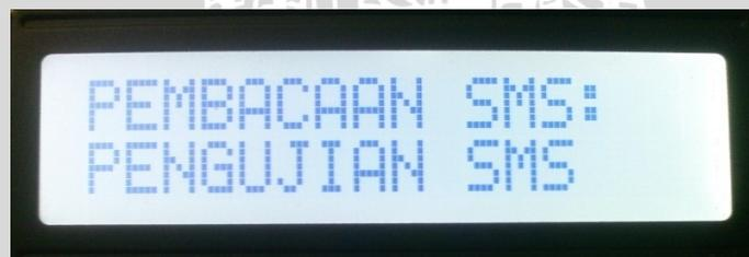
**Gambar 5.47.** Tampilan hasil pengujian pembacaan SMS pada LCD
