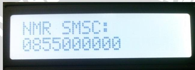
**Gambar 5.51.** Tampilan LCD proses memasukkan nomor SMS Center
