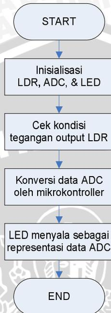
**Gambar 5.8.** Diagram alir pengujian sistem pendeteksi keberadaan manusia
