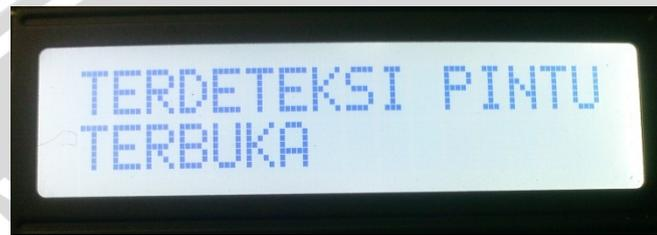
**Gambar 5.57.** Tampilan LCD saat sistem mendeteksi pintu terbuka
