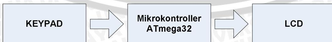
**Gambar 5.30.** Blok diagram pengujian keypad
