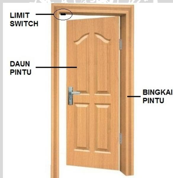
**Gambar 4.29.** Posisi penempatan sensor berupa *limit switch*
