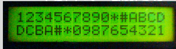
Gambar 5.4 Tampilan hasil pengujian antarmuka keypad dengan mikrokontroler
