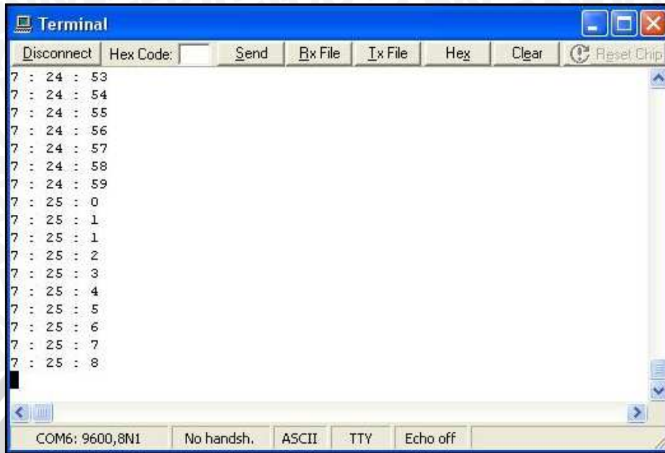
Gambar 5.21 Tampilan hasil pengujian sistem pewaktu RTC DS1307
