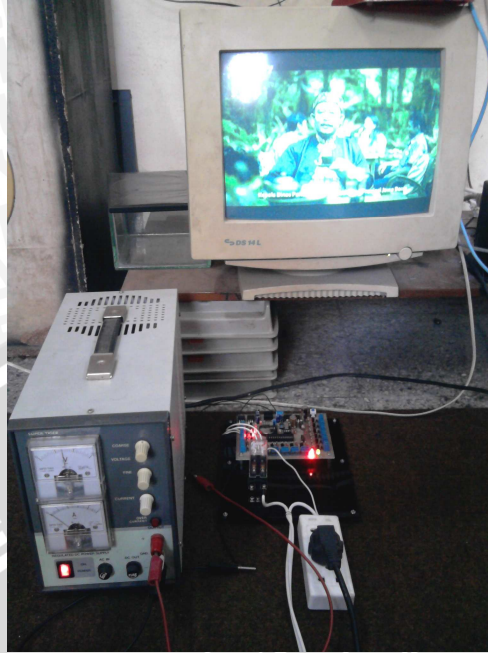
Gambar 5.25 Pengujian keseluruhan sistem dengan beban televisi Dari hasil pengujian tersebut dapat disimpulkan bahwa sistem dapat berfungsi sesuai perancangan, yaitu sistem dapat menyalakan televisi.
