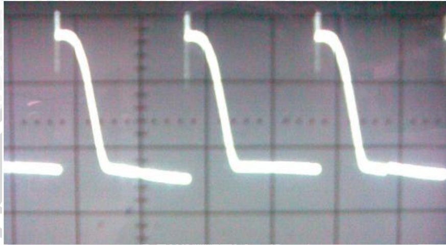
Gambar 5.24. Gambar Gelombang Tegangan Keluaran Penyearah Terkontrol Penuh Satu Fasa Hasil Pengujian dengan Sudut Penyalan 90^\circ
