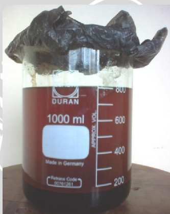
Gambar : Proses Pengendapan Lapisan metil ester/minyak bakar (atas) dan gliserol (bawah)
