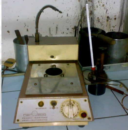
Gambar : Flash Point Pensky-martens Close Cup (Sumber : Laboratorium Uji Pelumas Pertamina Surabaya)
