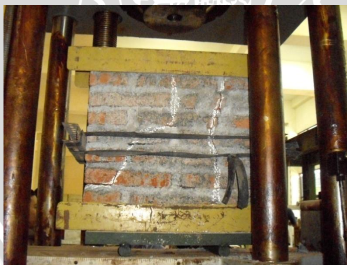
Gambar 16. Pola retakan yang terjadi pada dinding bata komposisi mortar 1:5, benda uji 2
