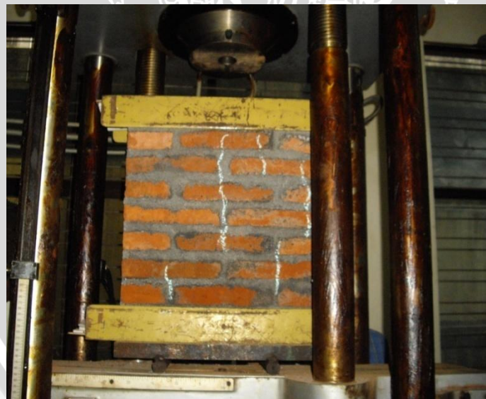
Gambar 12. Pola retakan yang terjadi pada dinding bata komposisi mortar 1:3, benda uji 1
