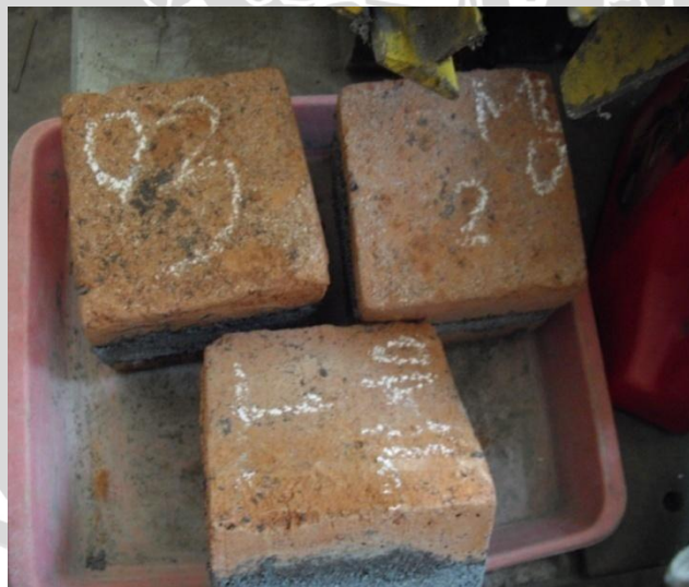
Gambar 2. Benda uji kuat tekan bata merah menurut SII 0021-78
