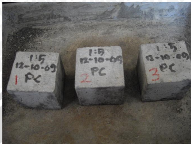
Gambar 5. Benda uji kuat tekan kubus mortar Komposisi mortar 1 : 5 Ukuran 5cm x 5cm x 5cm
