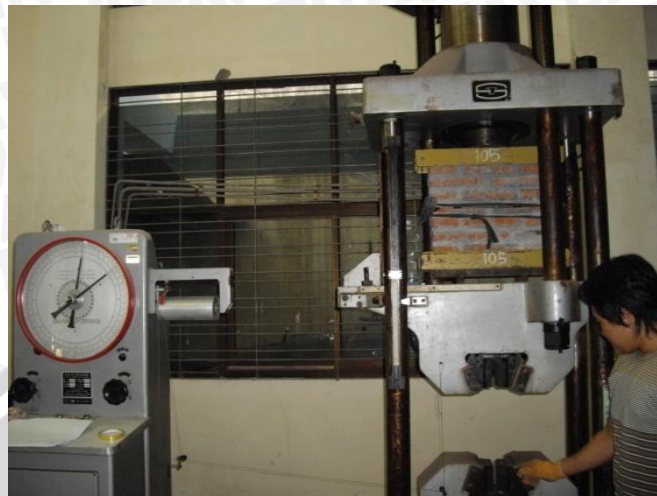
Gambar 11. Model dinding pasangan bata merah pada saat proses pengujian
