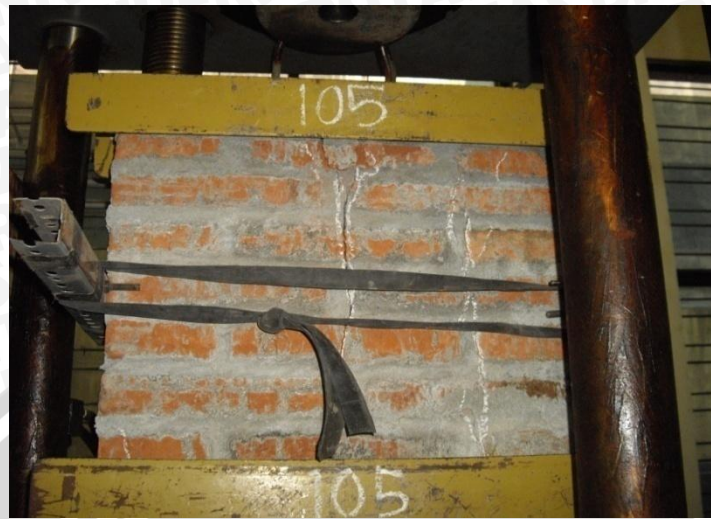
Gambar 13. Pola retakan yang terjadi pada dinding bata komposisi mortar 1:3, benda uji 2
