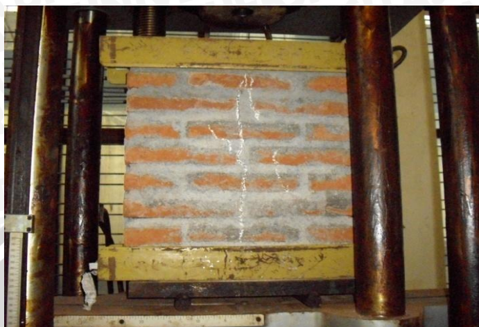
Gambar 15. Pola retakan yang terjadi pada dinding bata komposisi mortar 1:5, benda uji 1
