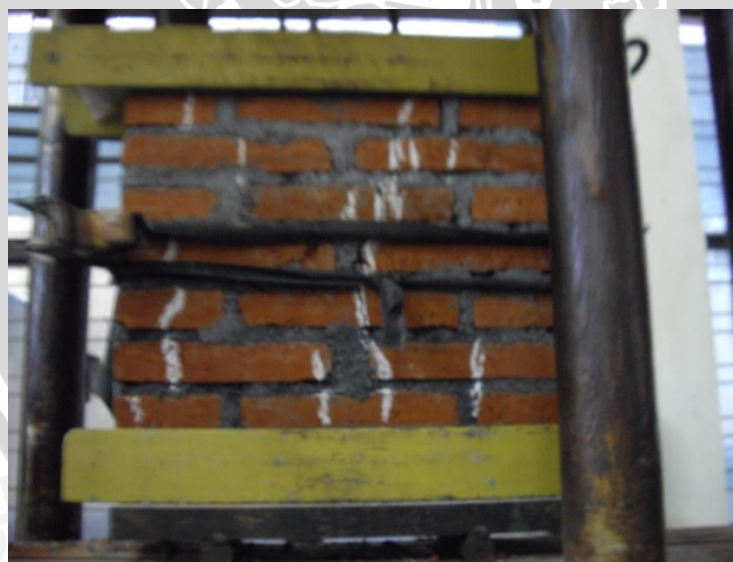
Gambar 20. Pola retakan yang terjadi pada dinding bata komposisi mortar 1:7, benda uji 3
