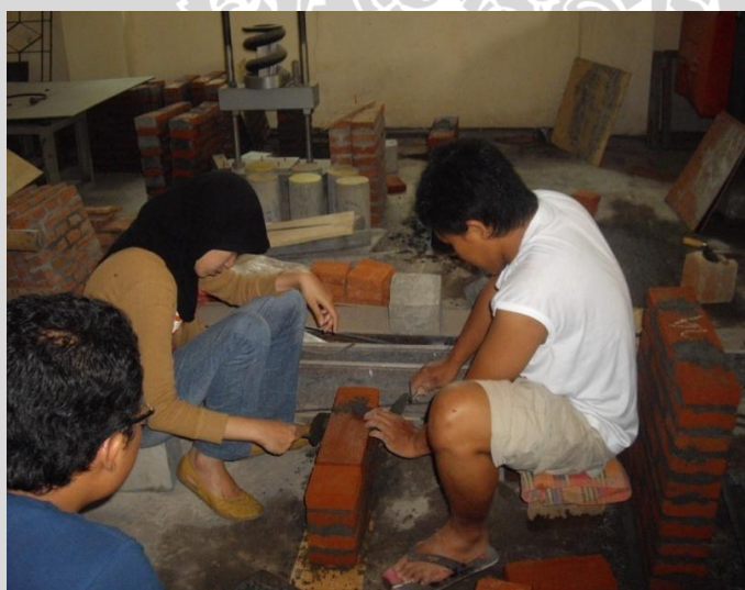
Gambar 8. Proses pembuatan benda uji dinding bata
