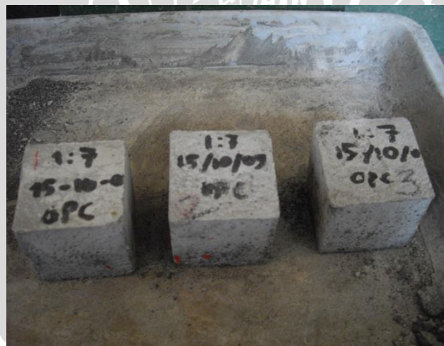
Gambar 6. Benda uji kuat tekan kubus mortar Komposisi mortar 1 : 7 Ukuran 5cm x 5cm x 5cm
