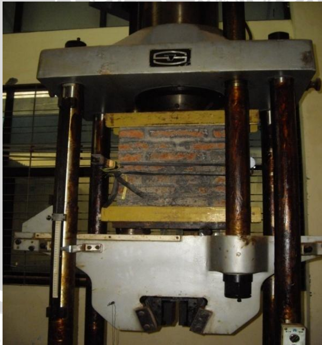
Gambar 10. Model dinding pasangan bata merah di mesin pengujian
