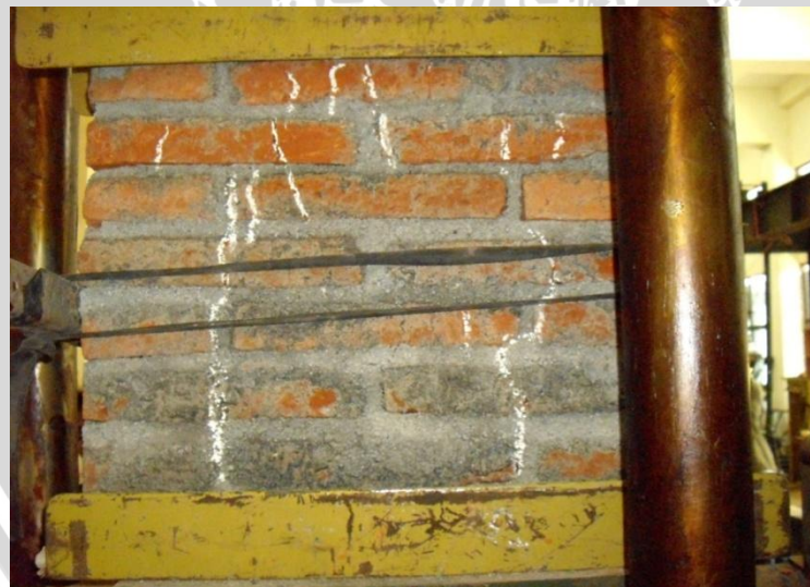
Gambar 18. Pola retakan yang terjadi pada dinding bata komposisi mortar 1:7, benda uji 1
