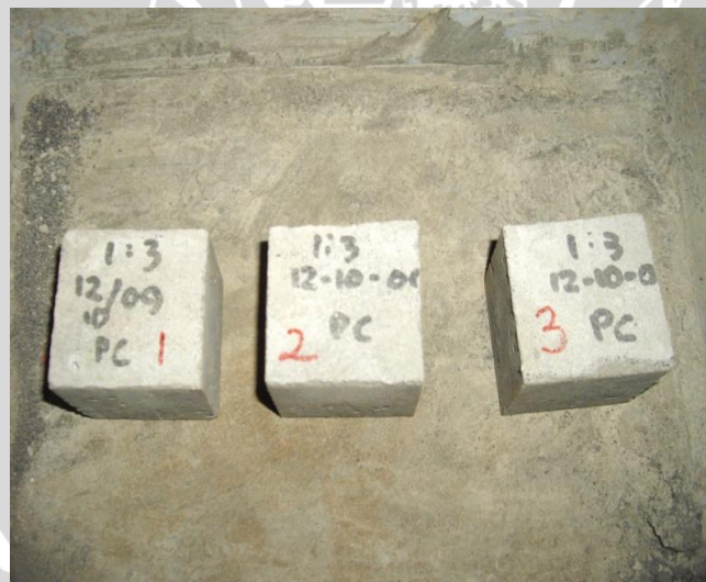
Gambar 4. Benda uji kuat tekan kubus mortar Komposisi mortar 1 : 3 Ukuran 5cm x 5cm x 5cm
