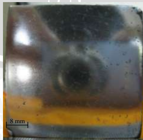
Gambar 4.10 Hasil foto makro pada spesimen dengan gaya Lorentz 41,4 \cdot 10^{-4} N
