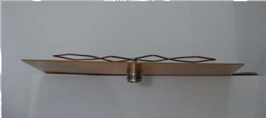
Gambar 4.8 Bentuk fisik antena double biquad hasil pembuatan tampak samping (Sumber: Pembuatan)
