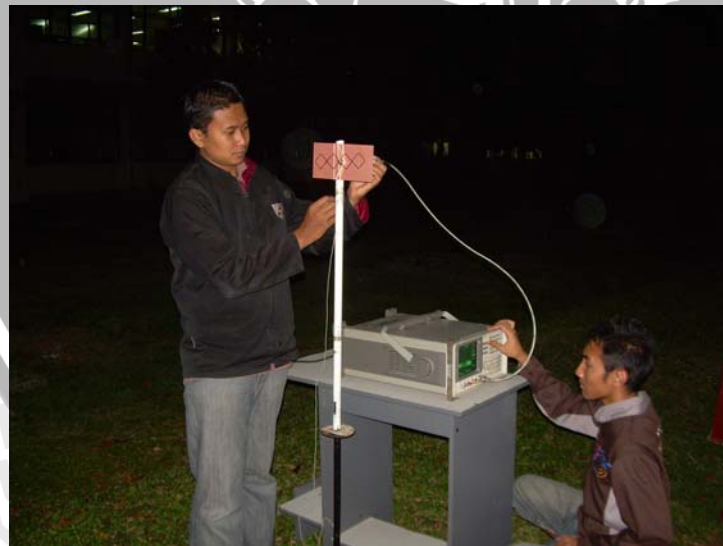
Situasi di lapangan saat proses pengukuran parameter antenna double biquad hasil pembuatan yang dilakukan pada malam hari
