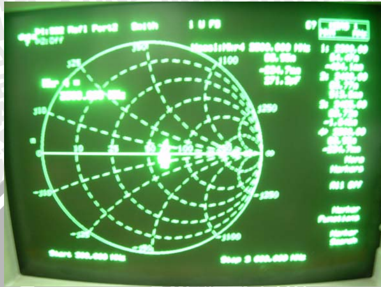
Hasil pengukuran Impedansi masukan dengan menggunakan network analyzer agilent 8714ES 300KHz-3GHz
