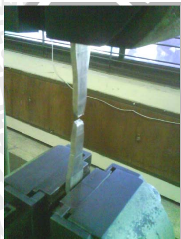
Gambar pengujian tarik saat patah.
