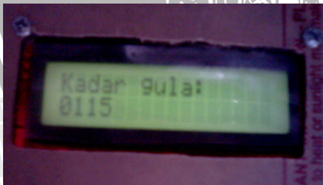
Gambar 5.6 Hasil Pengujian Sistem Secara Keseluruhan untuk Kadar Glukosa Darah 111 mg/dl
