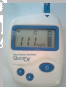
Gambar 5.6 Hasil Pengujian Sistem Secara Keseluruhan untuk Kadar Glukosa Darah 111 mg/dl
