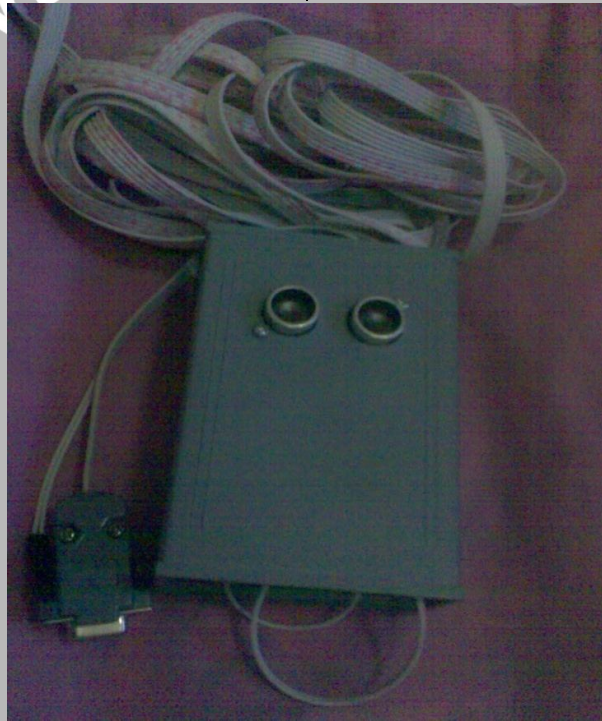
Alat Pemantau Tinggi Permukaan Air Sungai Tampak Depan
