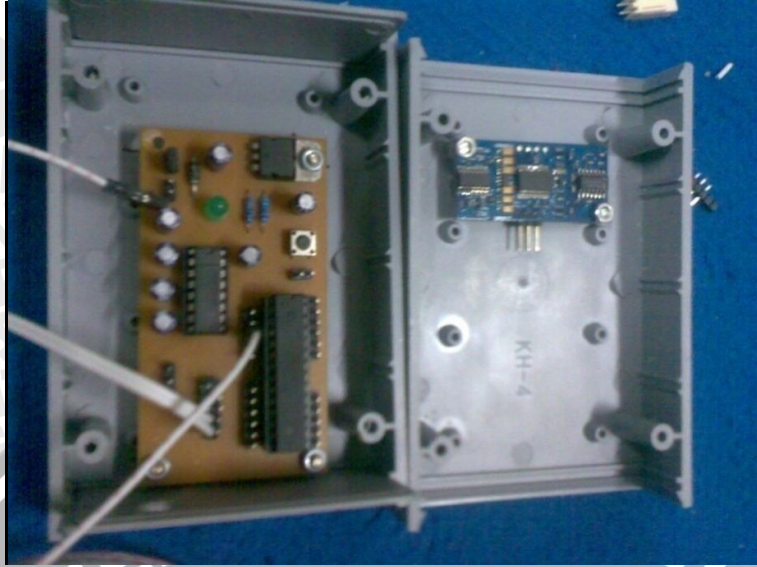
Alat Pemantau Tinggi Permukaan Air Sungai bagian dalam
