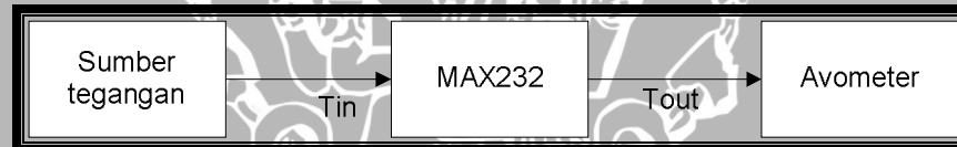
Gambar 5. 9 Blok diagram pengujian rangkaian MAX232
