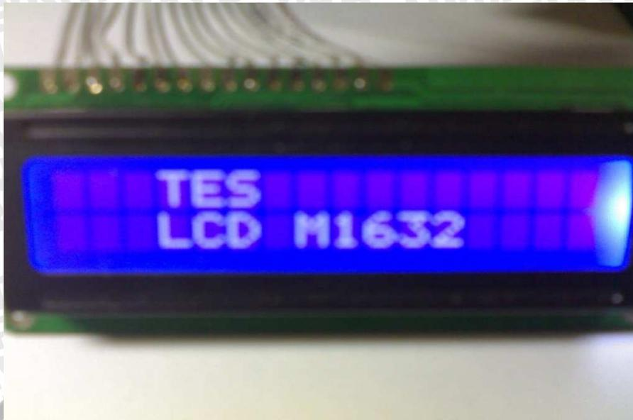
Gambar 4.2 Foto hasil percobaan tampilan LCD
