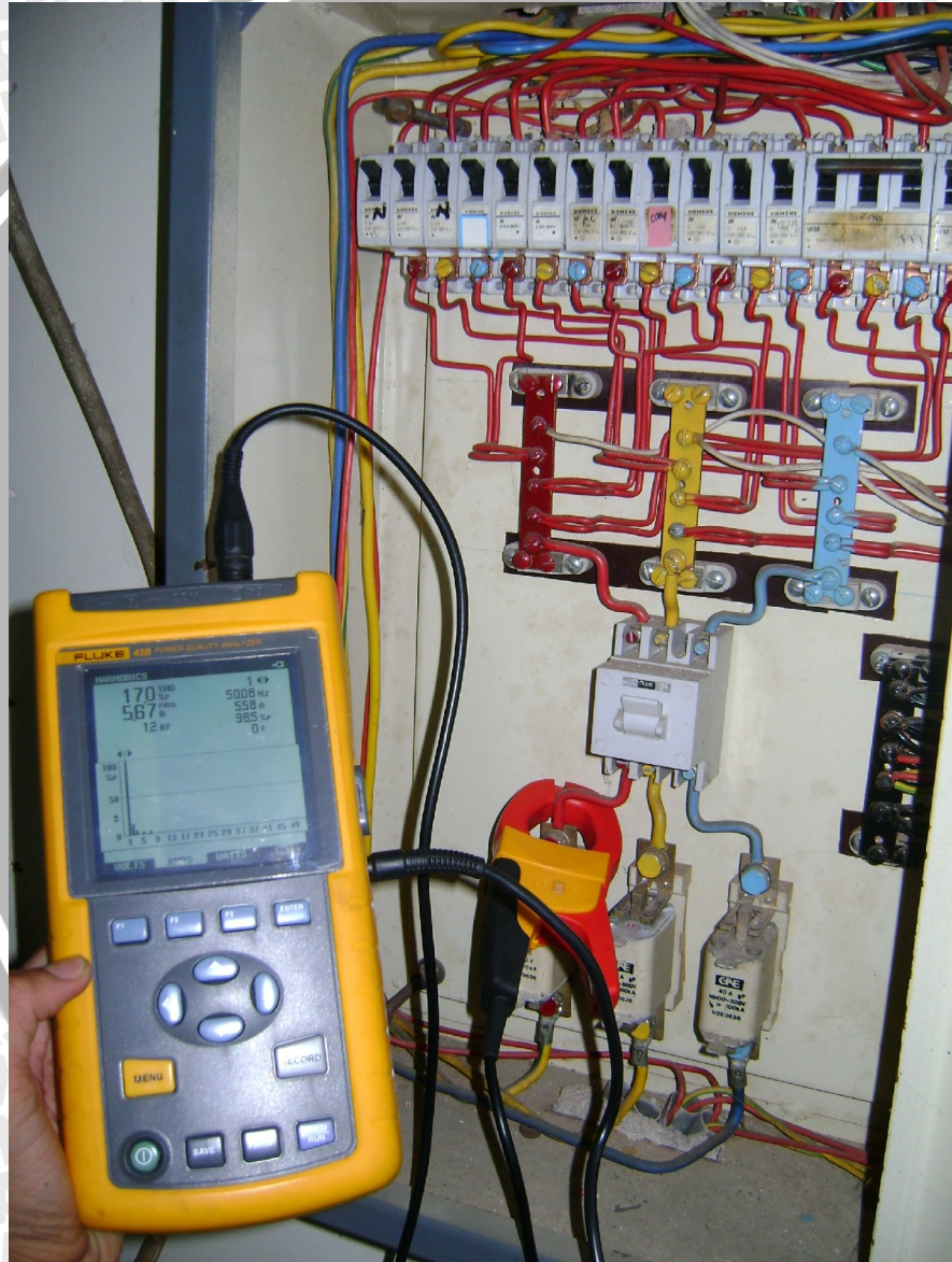
Gambar 3.3 Pengukuran arus harmonisa dengan Power Quality Analyzer
