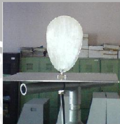
Gambar 5.6 Gambar posisi antenna planar monopole
