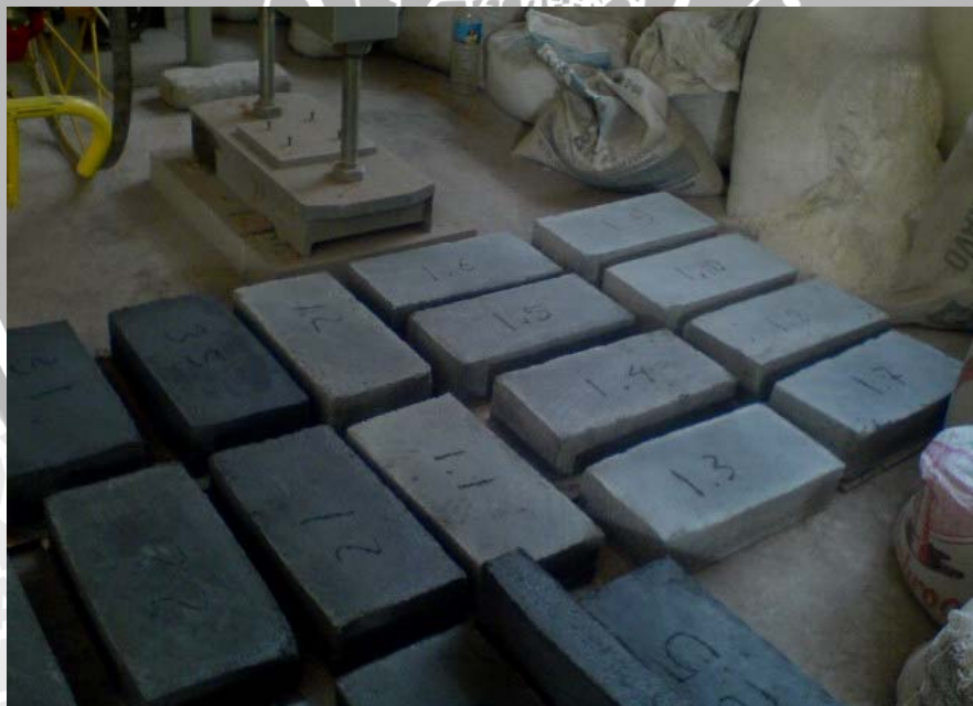
Perbedaan warna pada batako yang terdapat kandungan bottom ash dan batako normal tanpa bottom ash
