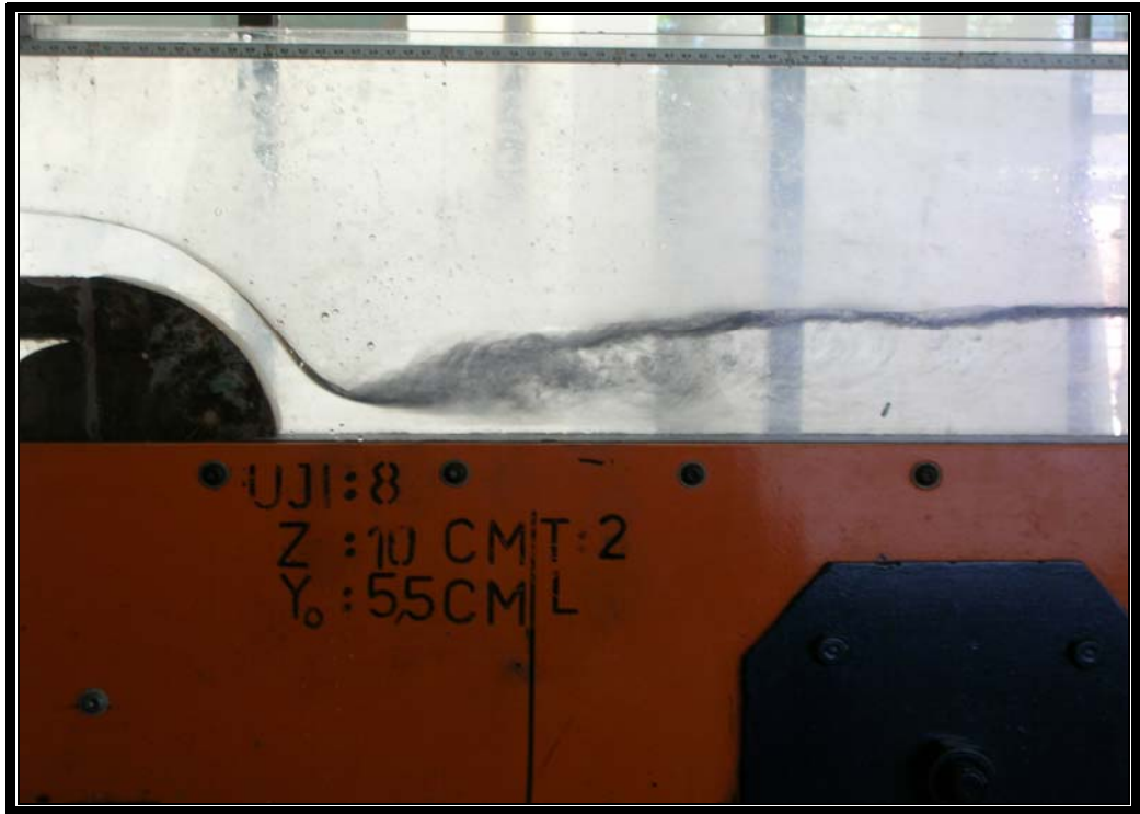
Gambar Pengaliran Pada Terjunan Radial Dengan Tinggi Muka Air Hulu 5,5 Cm
