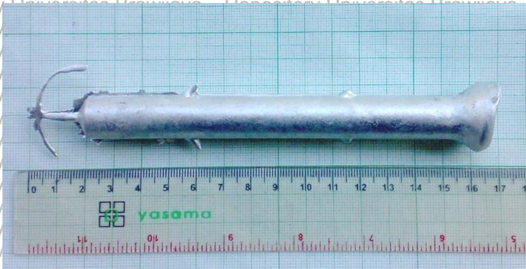
Gambar : Hasil Coran Spesimen Uji Korosi Sebelum *Finishing*
