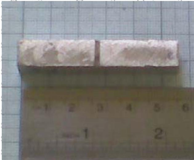
Gambar : Spesimen Uji *Impact* sesudah *Finishing*
