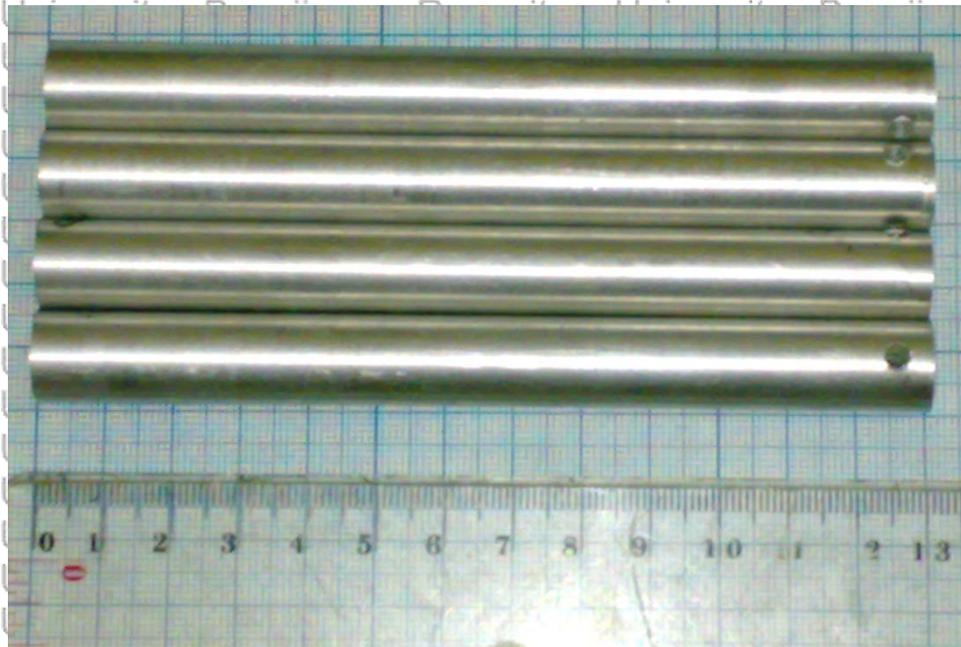
Gambar : Spesimen Uji Korosi Fraksi Berat 9% Zn
