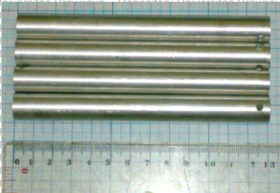
Gambar : Spesimen Uji Korosi Fraksi Berat 7% Zn
