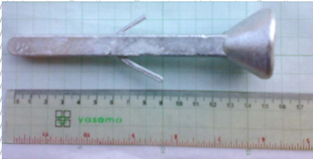
Gambar : Hasil Coran Spesimen Uji *Impact* Sebelum *Finishing*
