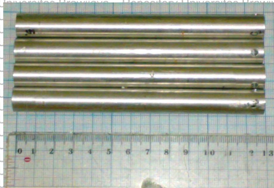
Gambar : Spesimen Uji Korosi Fraksi Berat 5% Zn
