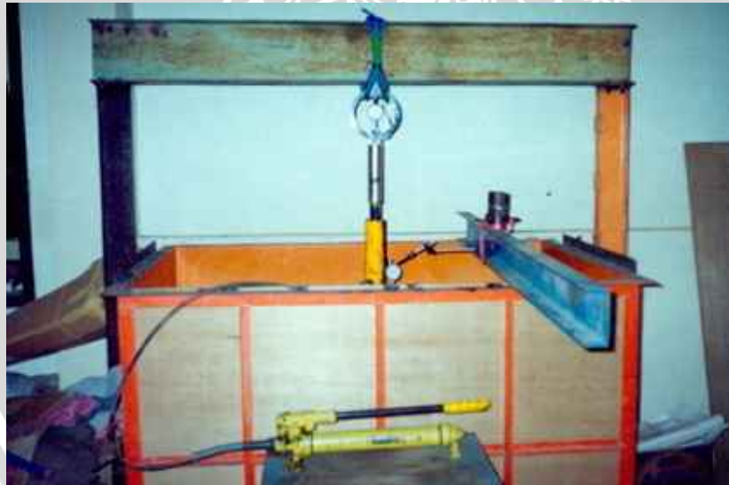
Boks Uji untuk Loading Test
