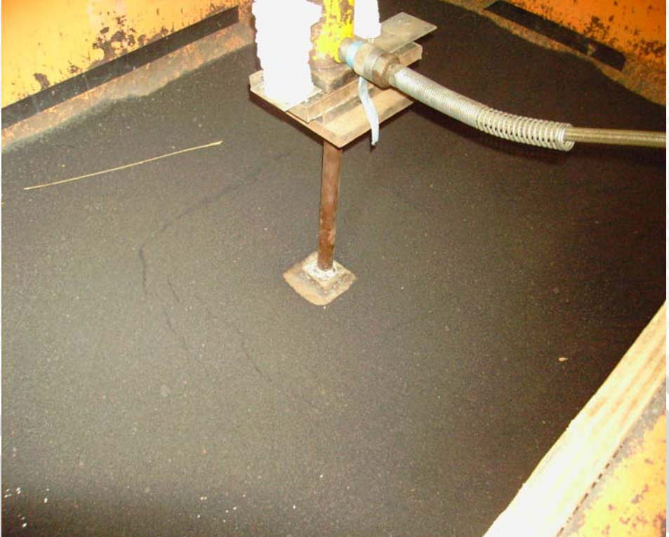
Model keruntuhan tanah setelah uji pembebanan
