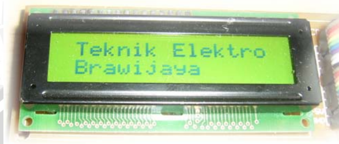
Gambar 5.6 Pengujian Program Menampilkan Karakter pada LCD
