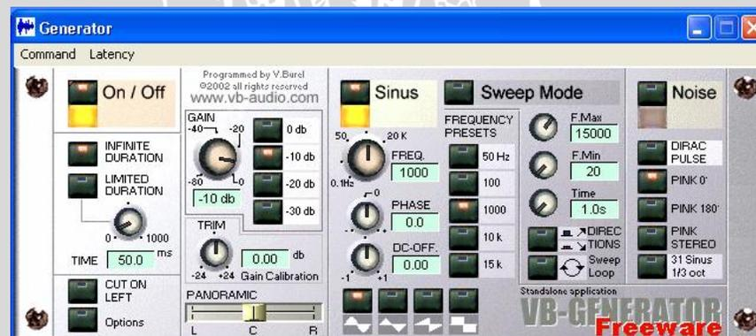
Gambar 5.1 Tampilan VB GENERATOR sebagai fungsi sinus generator dengan frekuensi 1Khz
