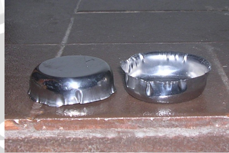
Kecepatan punch 1,2 mm/s Die kandungan Al_2O_3 37 gr
