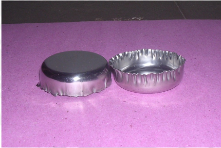
Kecepatan punch 0,6 mm/s Die kandungan Al_2O_3 17 gr
