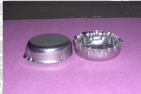
Kecepatan punch 12,4 mm/s Die kandungan Al_2O_3 17 gr
