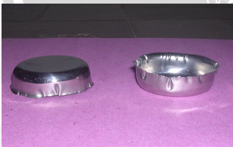
Kecepatan punch 3 mm/s Die kandungan Al_2O_3 47 gr
