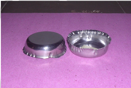
Kecepatan punch 1,8 mm/s Die kandungan Al_2O_3 27 gr
