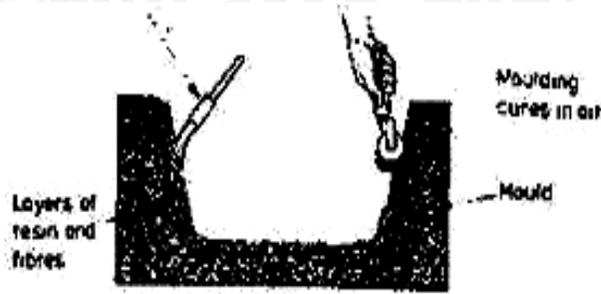
Gambar 2.10 Proses Cetakan *Hand lay up*
