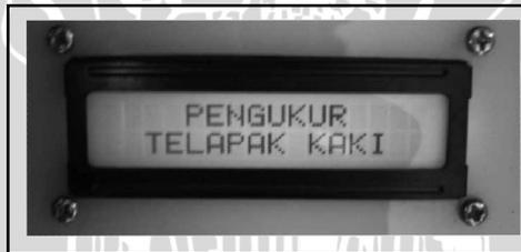
Gambar 5.4. Hasil tampilan pengujian LCD
