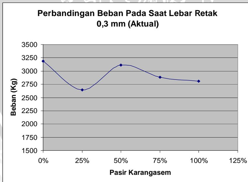
**Gambar 4.3** Grafik Hubungan  $P_{\text{Aktual}}$  dengan % Pasir Karangasem saat  $w = 0.3$  mm
