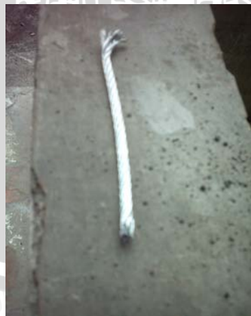
Gambar L.3. Hasil uji tarik kabel prategang
