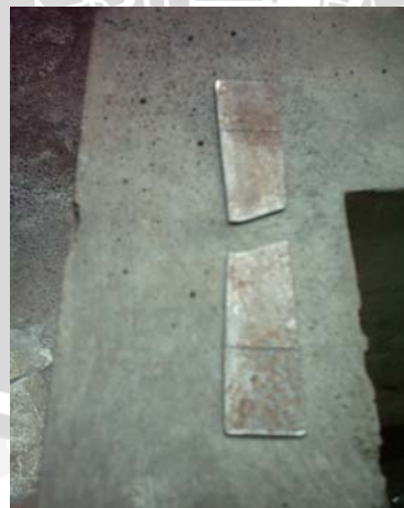
Gambar L.2. Hasil uji tarik profil baja
