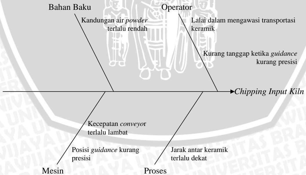
Gambar 4.5 Diagram sebab akibat untuk cacat *Chipping Input Kiln*
