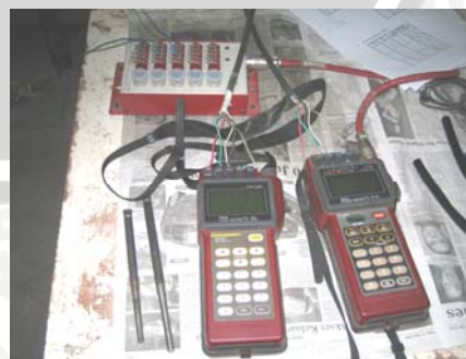
Gambar strainmeter (kiri bawah), loadmeter (kanan bawah), Paralel conector (atas)
