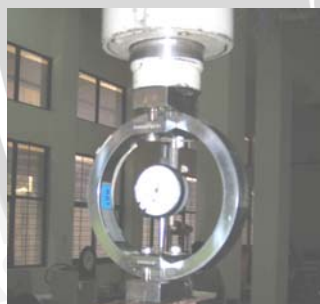
Gambar pemasangan profing ring
