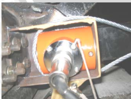
Gambar pemasangan loadcell
