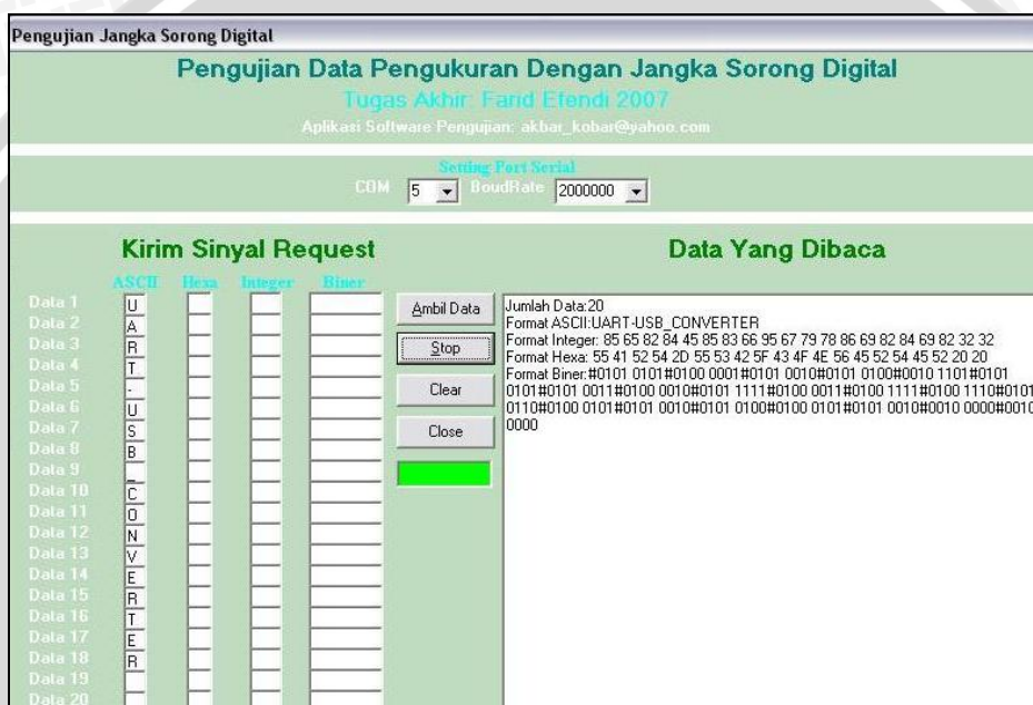
Gambar 5.13 Hasil pembacaan data dari alat oleh komputer
