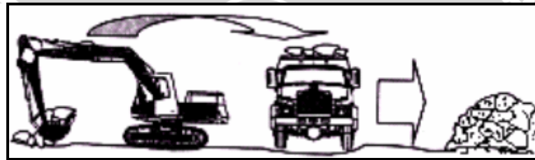
Gambar 4.17, Gambaran pekerjaan galian tanah Cofferdam
