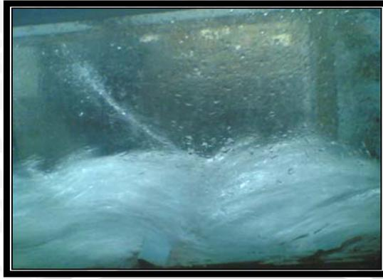
Gambar 4.17 Foto Loncatan air yang terjadi pada Peredam Energi USBR tipe III
