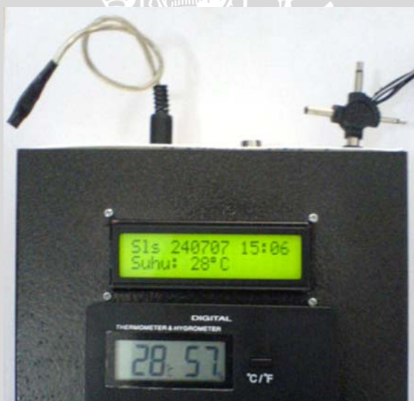
Gambar 5.32. Perbandingan hasil konversi alat dengan alat ukur lain
