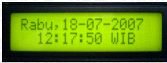
Gambar 5.6. Salah satu hasil pengujian RTC
