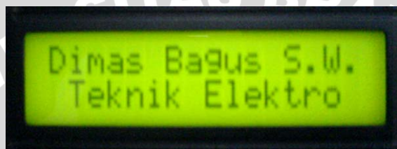
Gambar 5.13. Tampilan LCD hasil pembacaan EEPROM
