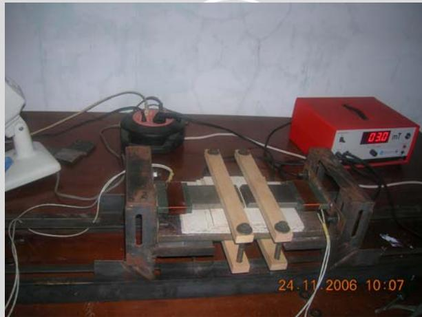
Instalasi pengukuran induksi magnet
