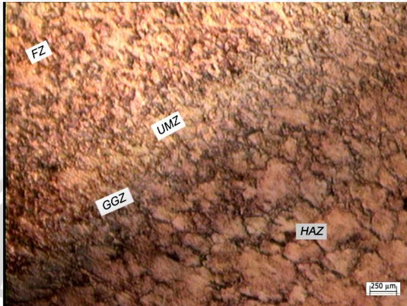
Foto mikro *fusion boundary* pada spesimen tanpa perlakuan Logam A EMS45
