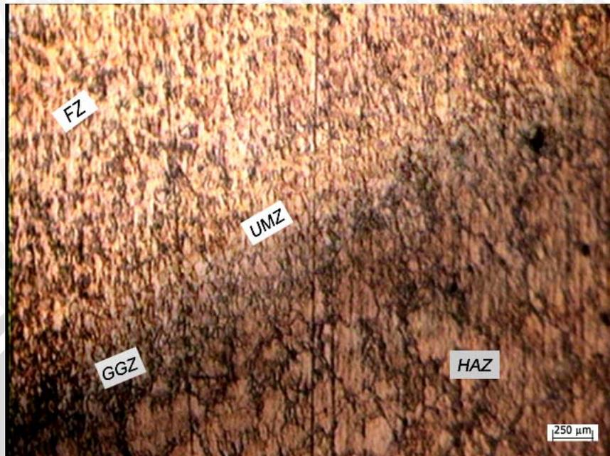
Foto mikro *fusion boundary* pada spesimen dengan pola pembangkitan medan magnet pola I pada logam A EMS45
