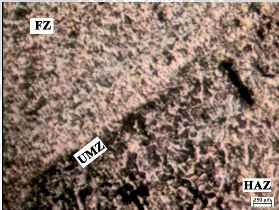
Foto mikro *fusion boundary* pada spesimen dengan pola pembangkitan medan magnet pola IV pada logam B. St37
