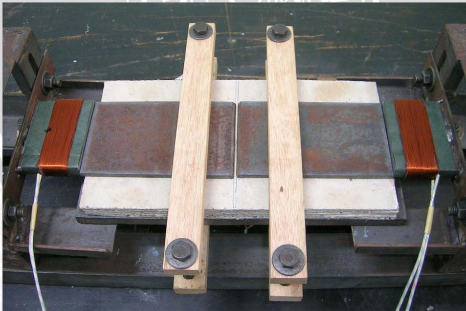
Peletakan magnet solenoida
