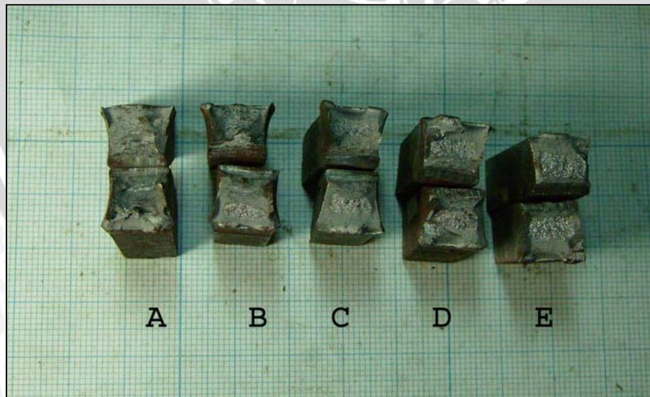
Gambar patahan spesimen uji impak setelah dilakukan pengujian
