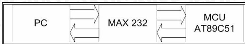
Gambar 5.7. Blok Diagram Komunikasi PC dengan MCU AT89C51
