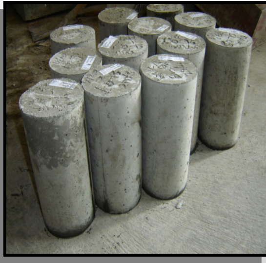
Benda uji selinder 15/30 untuk uji Tekan Beton dengan persentase penambahan pasir limbah kuningin yang berbeda
