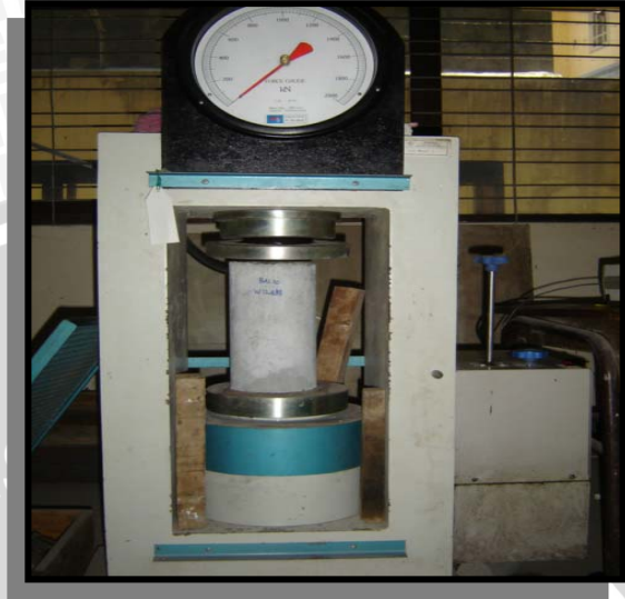
Benda uji selinder 15/30 untuk uji Tekan Beton dengan persentase penambahan pasir limbah kuningin yang berbeda
