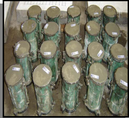
Pemadatan dan pembuatan benda uji beton dalam cetakan selinder 15/30
