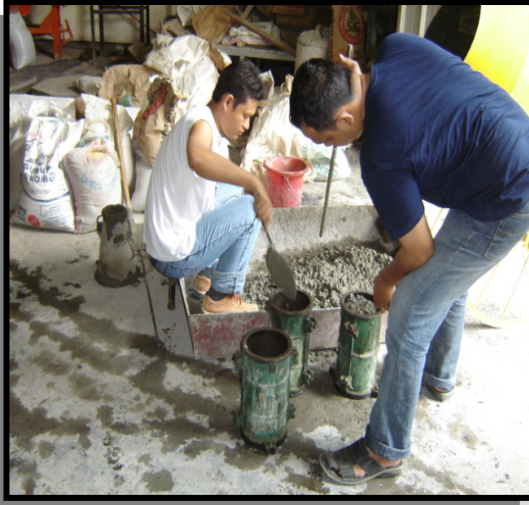
Pemadatan dan pembuatan benda uji beton dalam cetakan selinder 15/30
