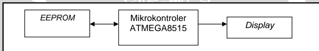
Gambar 5.9 Diagram blok pengujian *EEPROM* serial
