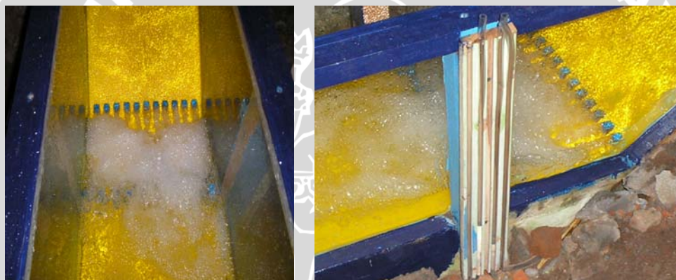
Gambar 4.10 Peredam Energi USBR Tipe III pada model test
