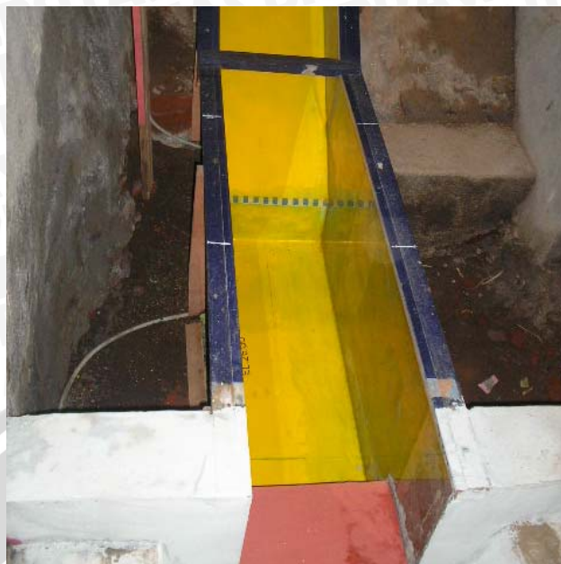
Gambar 4.16 Peredam Energi Modifikasi ( plunge pool ) pada model test
