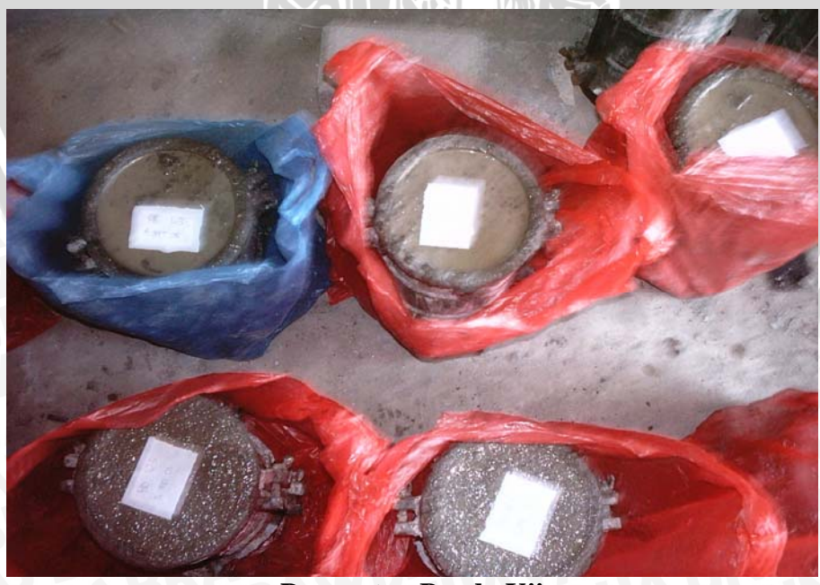
Perawatan Benda Uji
