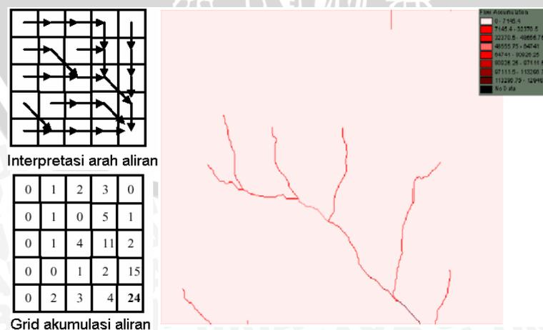
Gambar 2.30. Perhitungan komulatif aliran (flow accumulation)
