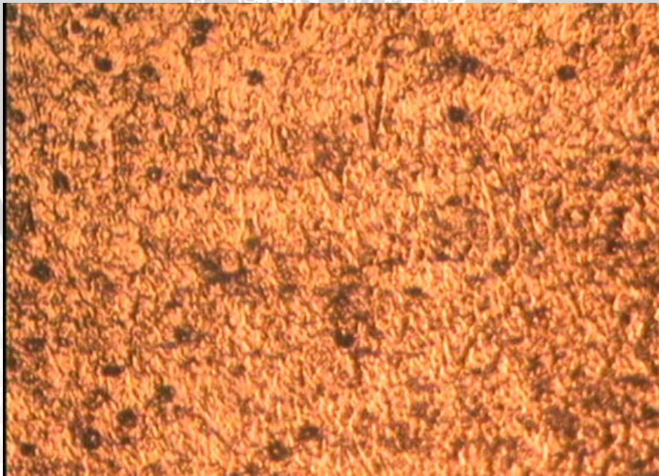
Gambar 4.1 Foto Struktur Mikro Aluminium seri 5120, dengan suhu pemanasan mula 100 °C dan pembesaran 100 X
